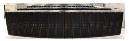
MCR, 11 TFlop/sec (#19/500) 1152 nodes, 2304 CPUs BlueGene/L, 70 Tflops/s (#1/500) 65536 nodes, 131072 CPUs
